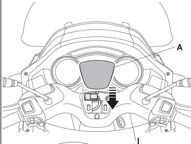
**D** Die Abdeckung **A** auf der oberen Lenkerverkleidung **I** aufsetzen und befestigen.
