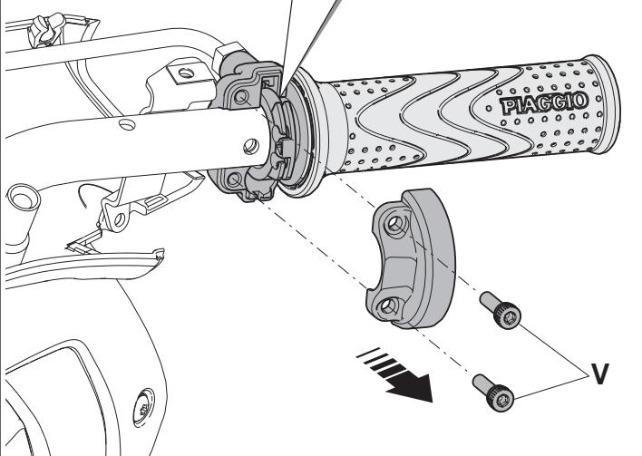
**D** Die Schrauben **T** abschrauben, dann die Halterung des Hauptbremszylinders **U** entfernen und den Hauptbremszylinder zur Mitte des Lenkers versetzen.
